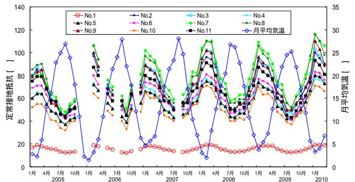
図 1 A 地点の接地抵抗の測定結果
