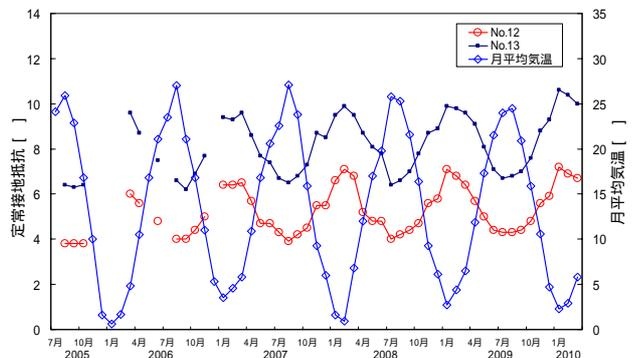
図 2 B 地点の接地抵抗の測定結果
